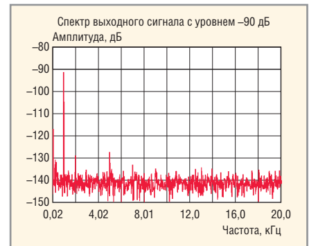
Рис. 5. Спектры выходного сигнала микросхемы PCM1704
