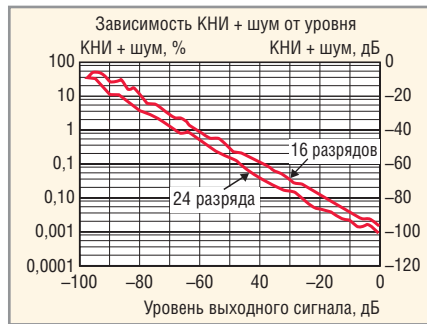
Рис. 4. Зависимость общих гармонических искажений и шума от уровня выходного сигнала микросхемы PCM1704
