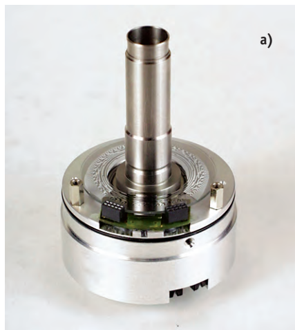
а) Кодировочный диск и специализированная интегральная микросхема (ASIC) установлены и отъюстированы с микронной точностью
