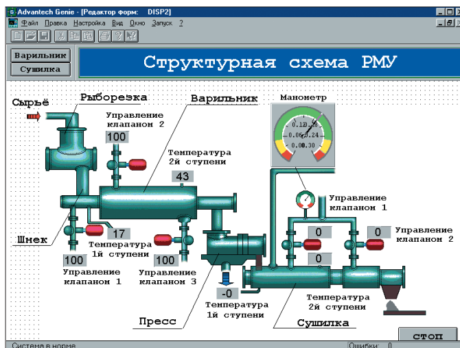
Рис. 8. Мнемосхема технологического процесса, сформированная в среде Genie
