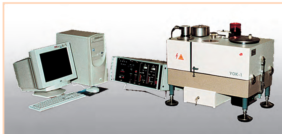
Рис. 7. Общий вид настольной установки для исследования и контроля характеристик люминесценции алмазов и сопутствующих минералов
