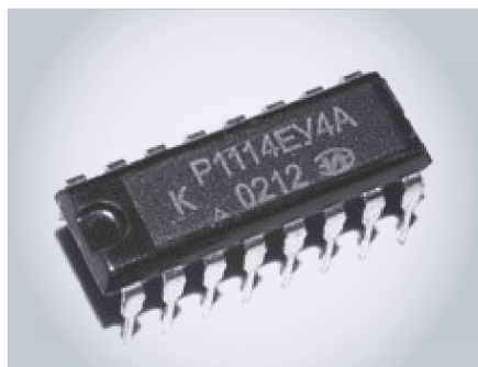
Рис. 1. Внешний вид микросхемы КР1114ЕУ4А
