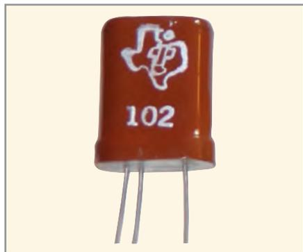
Рис. 1. Серийный германиевый транзистор Type 102
