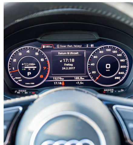
Рис. 11. Пример реализации информационной панели с использованием ЖК-дисплея свободной формы
