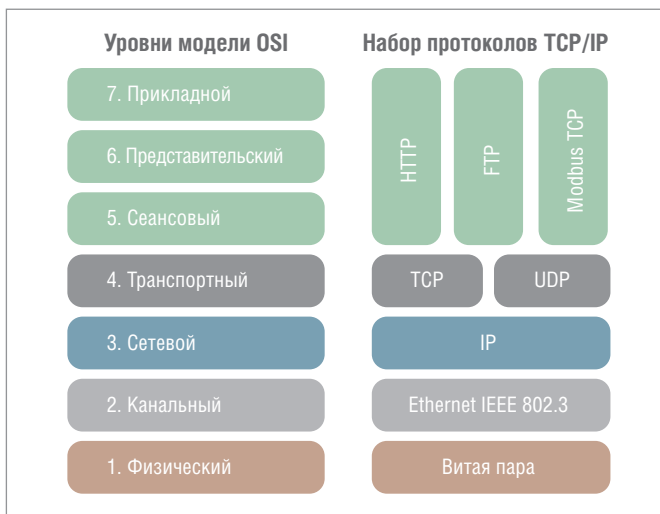
Рис. 2. Пример протоколов стека TCP/IP в соответствии с моделью OSI
