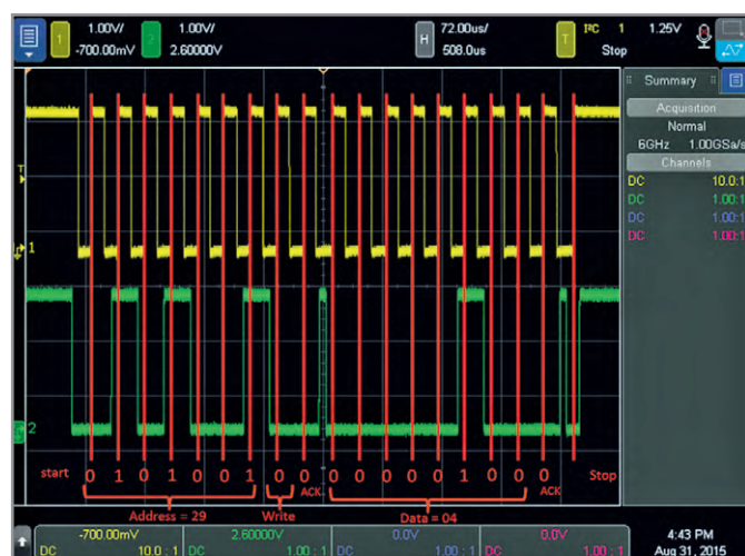
Рис. 1. Ручное декодирование данных шины I 2 C
