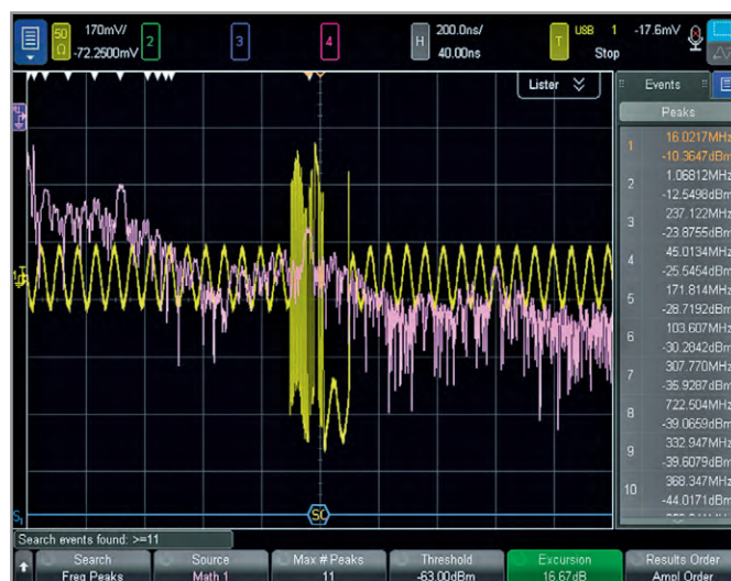
Рис. 8. Сигнал USB с шумом тактовой частоты 16 МГц
