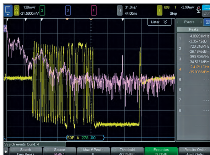
Рис. 9. Сигнал USB с шумом частотой 2,4 ГГц от беспроводной сети
