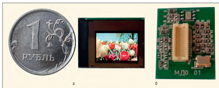
Рис. 1. Внешний вид микродисплея: а – фронтальная сторона; б – тыльная сторона
