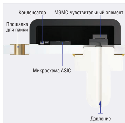
Рис. 8. Устройство BPS140
