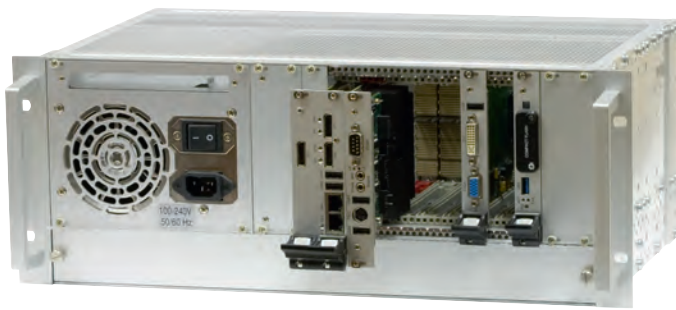
Рис. 2. Система стандарта CompactPCI
