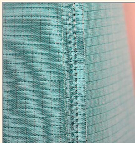
Сварные соединения, полученные с помощью ВС, особенно прочные, не деформируются, имеют эстетичный внешний вид и повышенную износоустойчивость. Благодаря создаваемой амплитуде колебаний и давлению, при котором происходит «спекание» материала, карбоновые нити буквально «срачиваются» на молекулярном уровне, позволяя изготовить цельноконтурное изделие. В настоящее время
