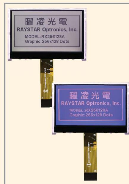
Из ряда RX256128A доступны ЖК-индикаторы, использующие материал STN (Super Twist Nematic) или FSTN (Film Compensated STN): модели RX256128A-BIW, RX256128A-DIW, RX256128A-FHW.
