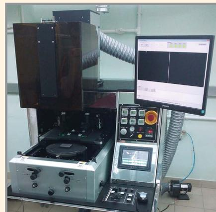
При необходимости AG500-6N-ST работает и с круглыми полупроводниковыми пластинами диаметром 2", 3", 4" и 6". Для этого надо лишь заменить шаблондержатель и подложкодержатель. Процедура занимает менее трёх минут. Таким образом, данная установка в полном объёме удовлетворяет все текущие и перспективные потребности фотолитографического производственного участка.
