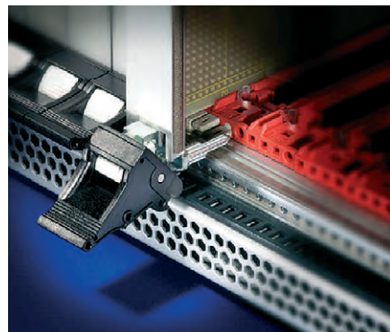
Рис. 5. Установка модуля CompactPCI с помощью специальной ручки
