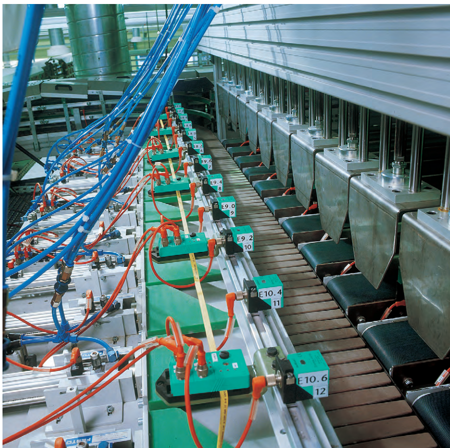
Рис. 1. Оборудование сети AS-интерфейса для конвейерной линии
