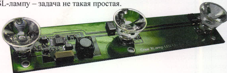
Образец готового изделия: линейка из трёх ламп серии XLamp™ 7090 с линзами и интегрированным управляющим контроллером для встраивания в автономные осветительные приборы
