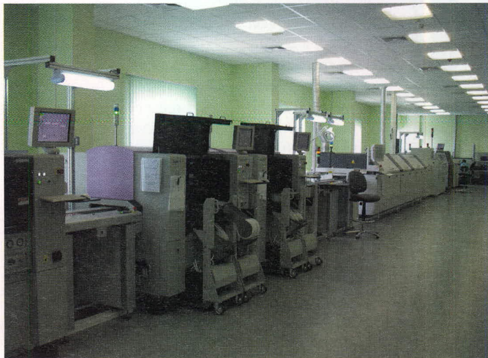
Линия поверхностного монтажа компонентов Fastwel
