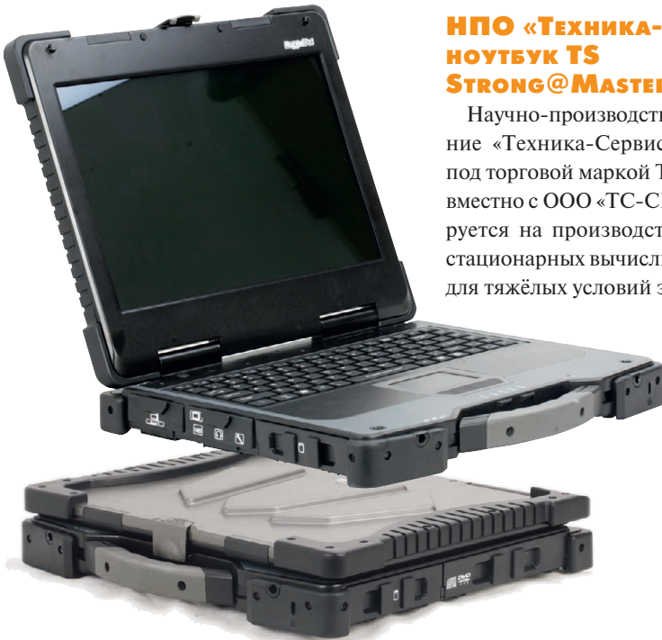
Рис. 6. Защищённый ноутбук JNB-1406 в открытом и закрытом состоянии
