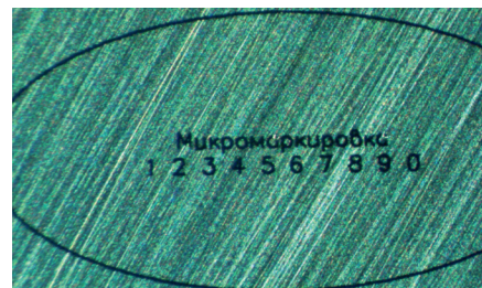
Рис. 3. Микромаркировка по полированному кремнию, высота букв – 50 мкм
