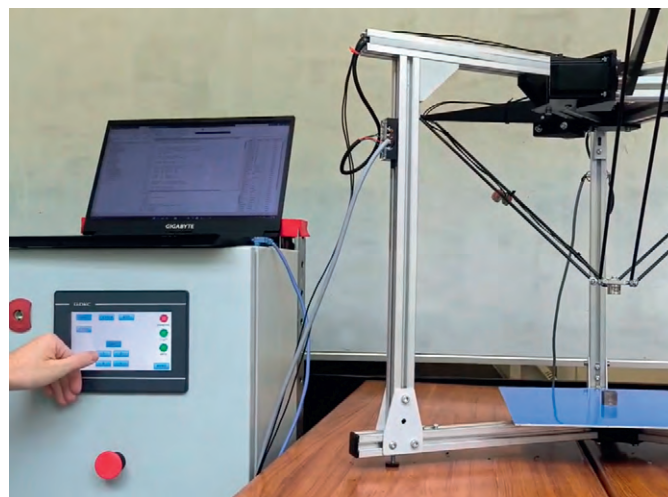
Рис. 3. Стенд № 2. Управление скоростью двигателя с обратной связью
