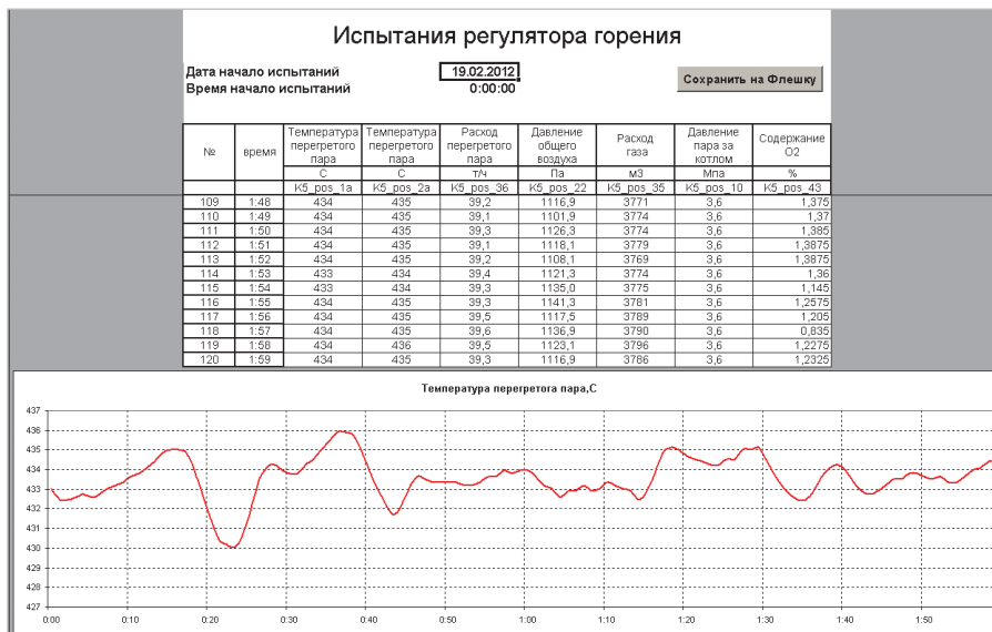
Рис. 7. Экранная форма протокола испытаний регулятора горения
