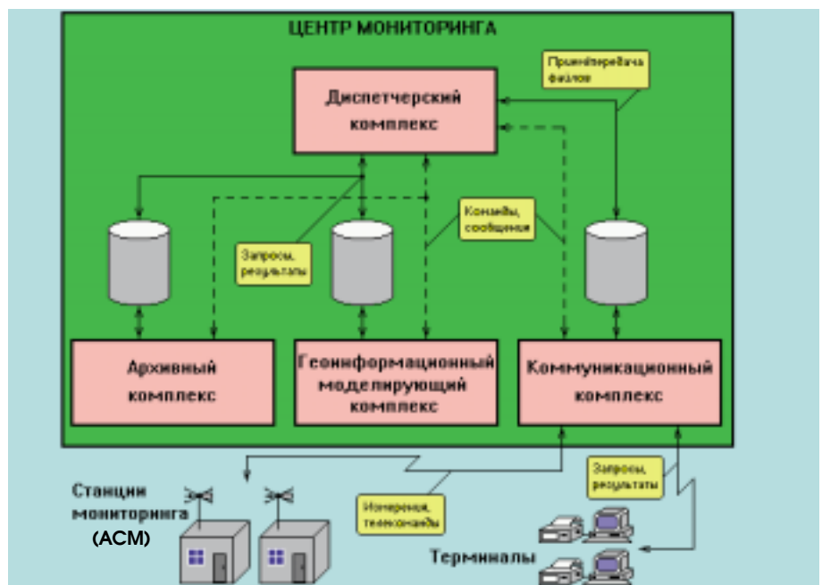
Рис. 5. Технология обработки информации в Центре мониторинга
