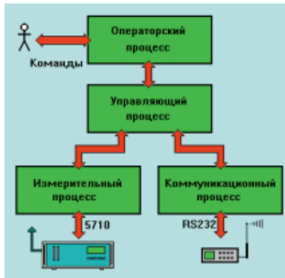
Рис. 4. Схема функционирования программного обеспечения станции мониторинга
