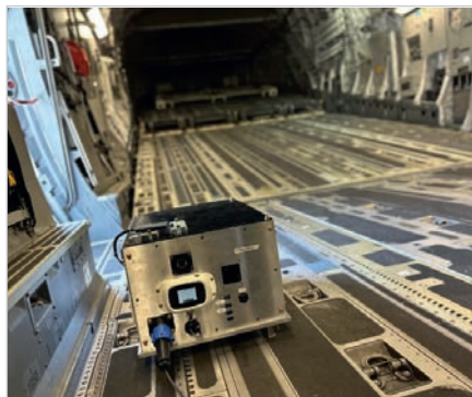
Рис. 8. Квантовая электромагнитная навигационная система AQNav в трюме грузового самолёта C-17
