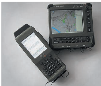
Рис. 13. Индивидуальный тактический терминал модели ТТ-6.5
