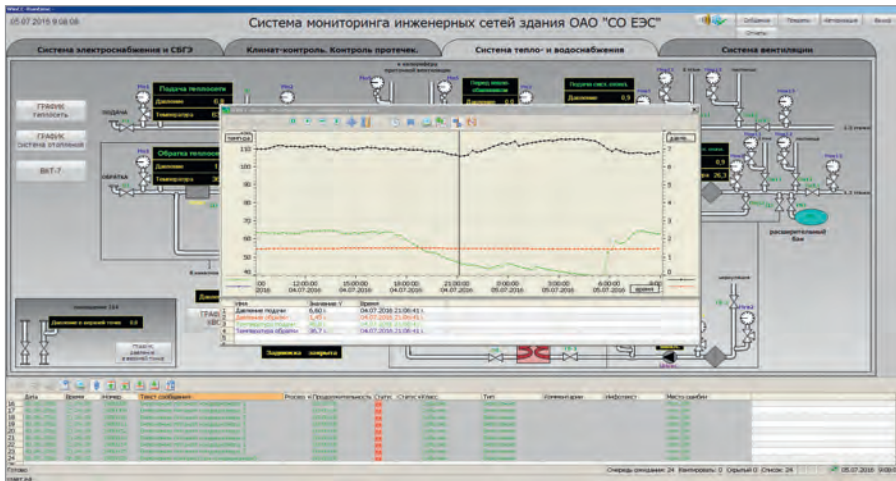
Рис. 8. Экранная форма системы тепло- и водоснабжения с всплывающим окном графиков температур и давлений
