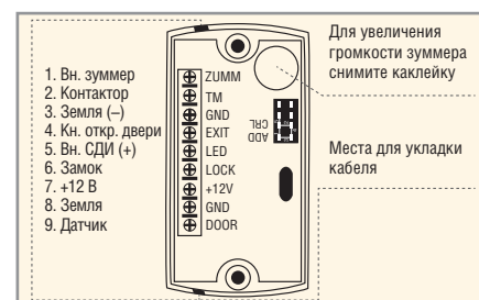
Рис. 2. Назначение контактов контроллера для подключения электрической цепи управления
