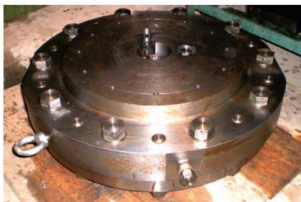
Рис. 10. Гидрокапсула в процессе замены мембраны
