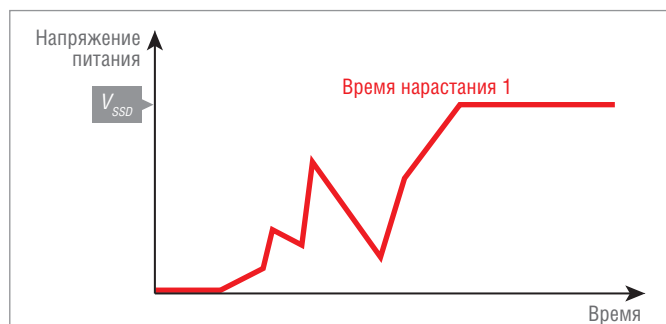
Рис. 2. Колебания напряжения при разгоне SSD
