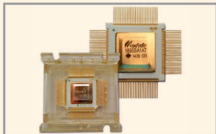
Микросхемы, управляемые микропроцессором, обеспечивают организацию обмена информацией и контроля передачи информации по резервированному мультиплексному каналу передачи данных (МКПД) в режимах контроллера шины, оконечного устройства и монитора шины.
