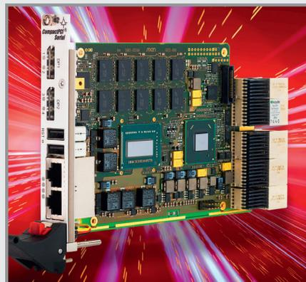
дуктов, CompactPCI Serial полностью контролирует машины и соответствующие камеры для сбора продукции, её хранения и архивации фотографий. Преимущество CompactPCI Serial по сравнению с обычным промышленным ПК – это компактная конструкция системы, которая сочетает несколько функций управления на двух процессорных платах в одной платформе. Кроме того, решение с CompactPCI Serial – наиболее выгодная альтернатива с экономической точки зрения.
