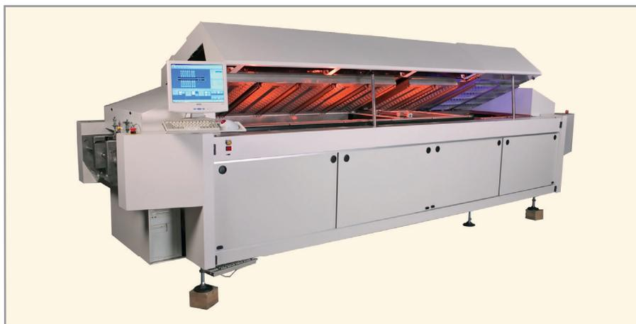
Рис. 4. Конвекционная печь оплавления Electrovert
