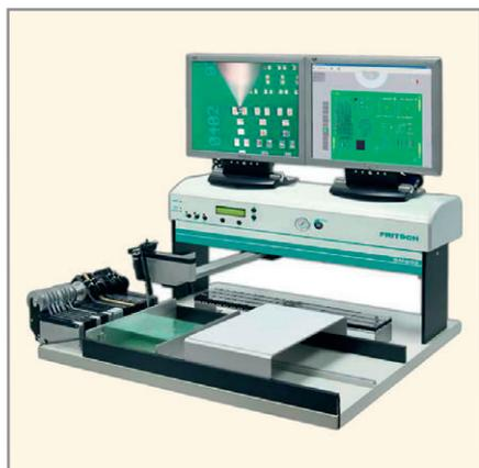
Рис. 3. Полуавтомат для установки ПМИ SM902 FRITSH
