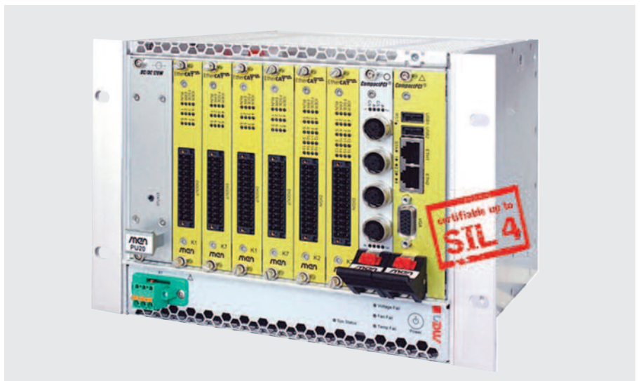
Рис. 1. Сертифицированная система управления движением SIL 4 MEN основана на открытом стандарте CompactPCI
