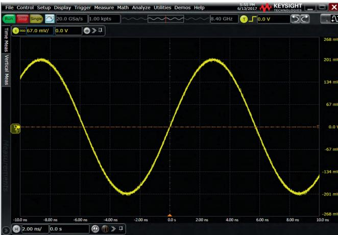
Рис. 2. Установка уровня посередине сигнала на осциллографе Keysight Infiniium серии S
