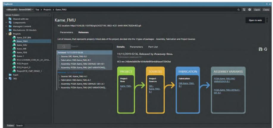
Рис. 4. Отображение релиза (публикации) управляемого проекта на сервере Altium Concord Pro в панели Explorer Altium Designer
