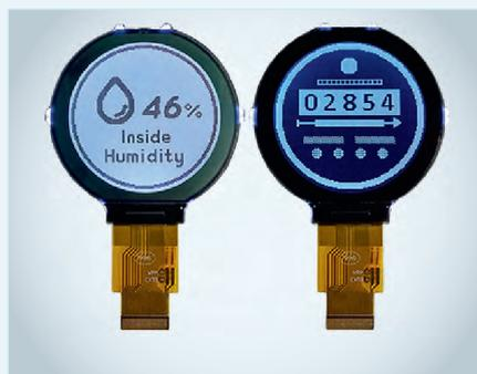
Напряжение питания для логической части дисплея RX128128A от 2,7 до 3,3 В (типичное значение 3 В). Дисплейный модуль способен работать в диапазоне температур от -20 до +70°C, температура хранения от -30 до +80°C.
