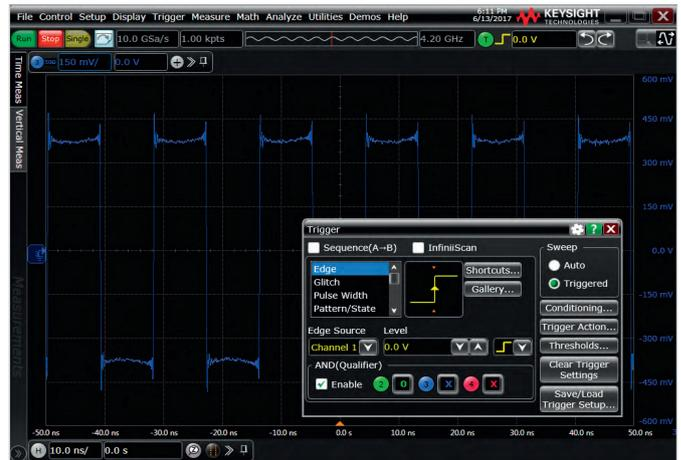
Рис. 8. Отображение только третьего канала при запуске от первого и второго каналов
