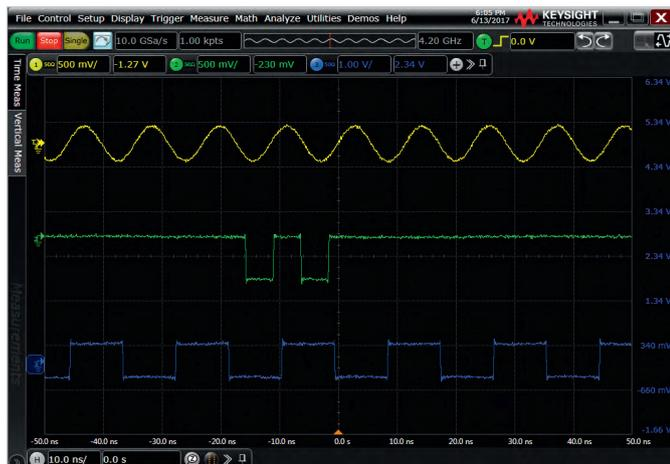
Рис. 5. Три различных сигнала, одновременно отображаемых на экране осциллографа Keysight Infiniium серии S
