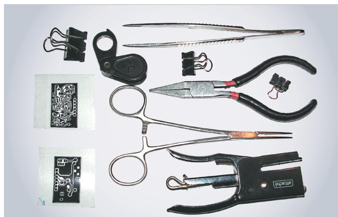
Рис. 9. Инструменты и приспособления для получения двустороннего фотошаблона
