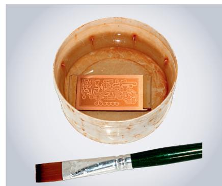
Рис. 22. Проявление заготовки в растворе «Крота»
