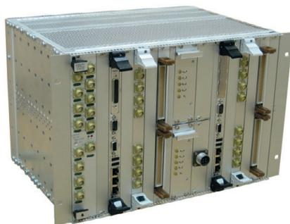
Рис. 5. Внешний вид крейта ЦВС с электронно-вычислительными средствами на базе шины cPCI 6U
