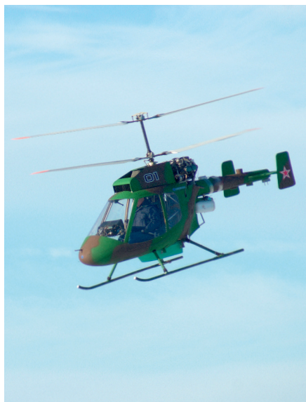
Рис. 2. Сверхлёгкий вертолёт с соосной схемой расположения винтов
