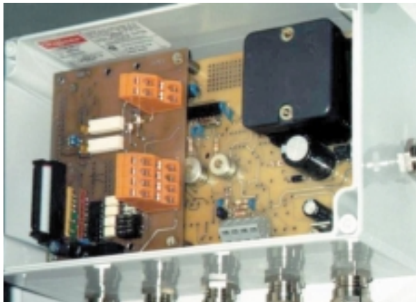
Рис. 8. Внутренняя конструкция контроллера «Мега»
