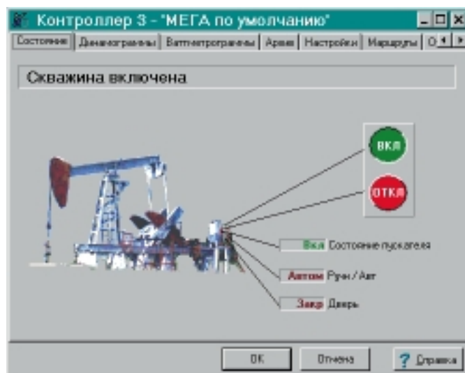
Рис. 11. Управление работой скважины из диспетчерского пункта
