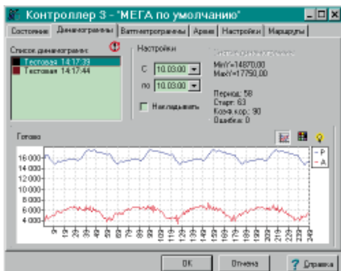
Рис. 10. Диагностика неисправностей насосного оборудования скважины по динамограмме
