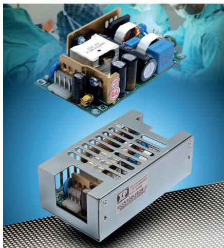
Рис. 3. Источники питания серии ECS100 (XP Power) обеспечивают в нагрузке мощность 80 Вт, значение КПД 88% даёт возможность использовать конвекционный отвод тепла при данном значении мощности
