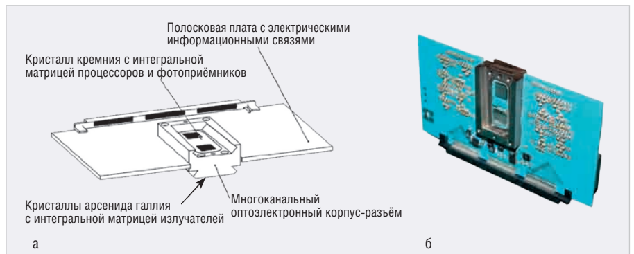
Рис. 62. Вычислитель с 3D МЭФ М на базе механического интерфейса «планка Пикатинни»: а) концепция; б) фотография опытного образца
