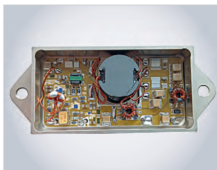
Рис. 5. Внешний вид модуля серии HMTF28 с удалённой крышкой (макетный образец)
