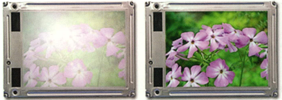
Рис. 2. Результат пассивного увеличения яркости задней подсветки
