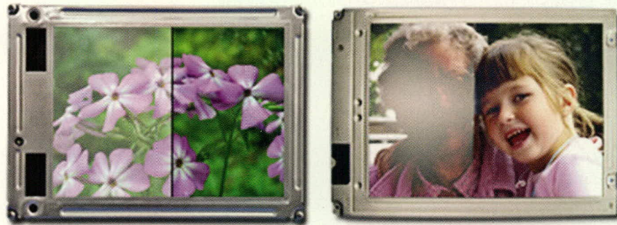
Рис. 4. Сравнение контраста ЖК-панели с ламинированной поверхностью (справа) и без неё (слева) при яркой внешней засветке
