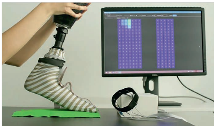
Рис. 3. Вид электронного носка с чувствительными датчиками для медицинского протеза
