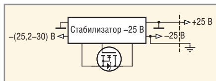
Рис. 17. Получение стабилизированного напряжения +25 В с помощью стабилизатора -25 В
