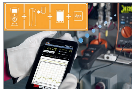
Рис. 3. Беспроводной мониторинг электрического тока на промышленном предприятии с помощью планшета с ОС Android, промышленного мультиметра Agilent U1273A с индикатором на органических светодиодах, адаптера ИК-Bluetooth Agilent U1177A и ПО Agilent Mobile Logger (доступно бесплатно через магазин Google Play)
