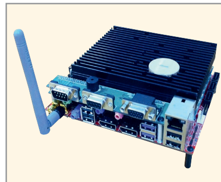
Рис. 4. Носитель «Кена» имеет габариты 150 × 25 × 48 мм и может применяться в устройствах с активным и пассивным охлаждением
