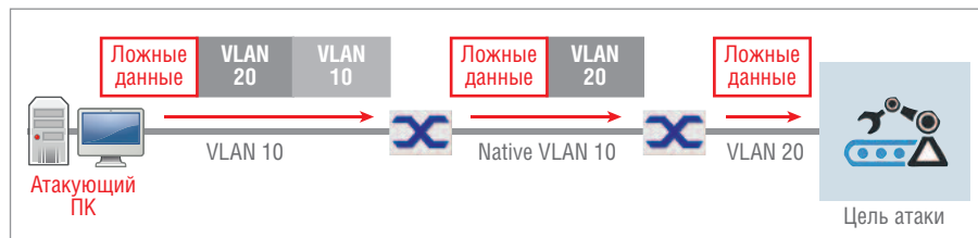
Рис. 4. Пример атаки типа VLAN hopping/Double tagging attack
