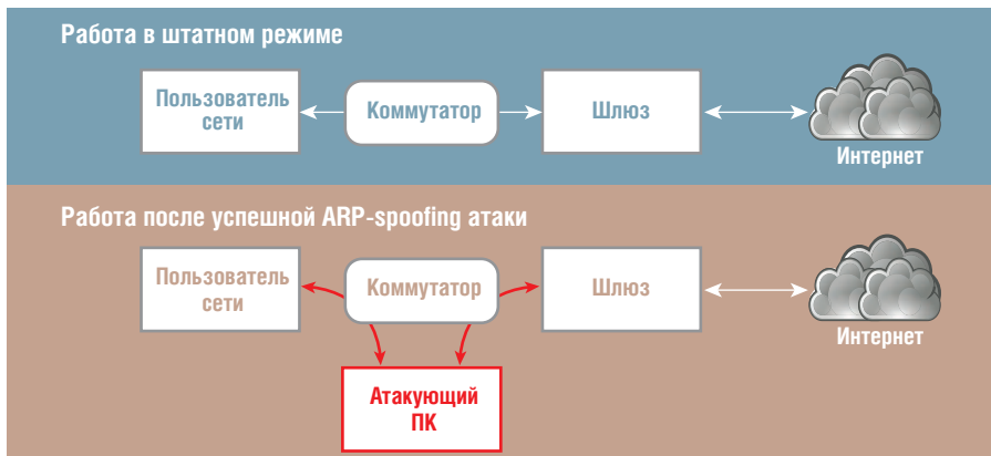
Рис. 2. Пример ARP-spoofing атаки
