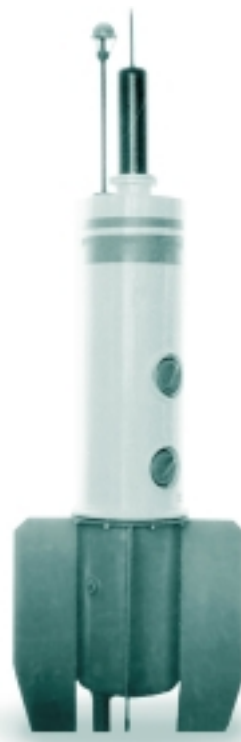
Рис. 7. Внешний вид дрейфующего буя Лобан, оснащенного аппаратурой связи «Курс» и измерительными каналами температуры воды и воздуха
