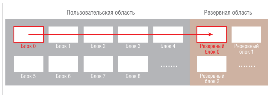
Рис. 4. SSD начинает запись в резервный блок 0
