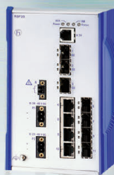
Серия RSP – промышленные коммутаторы МЭК61850
