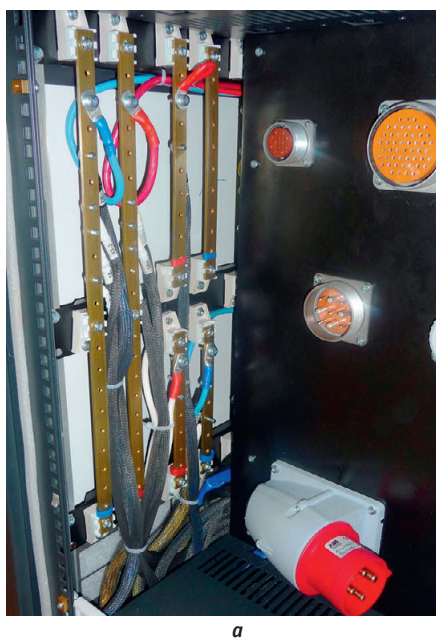
Рис. 7. Расположение входных соединителей (а) и выходных шин питания постоянного тока (б) внутри имитатора варианта 1
