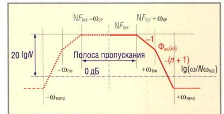
Рис. 7. ЛАХ коэффициента передачи помех, приходящих с опорным сигналом на выход импульсного кольца ФАП с ДПКД на N в цепи обратной связи
