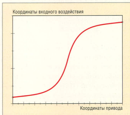
Рис. 6. Форма изменения входного воздействия на выходе фильтра
