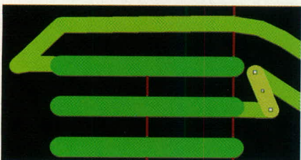
Рис. 12. Ликвидация нарушений после переименования контактов
