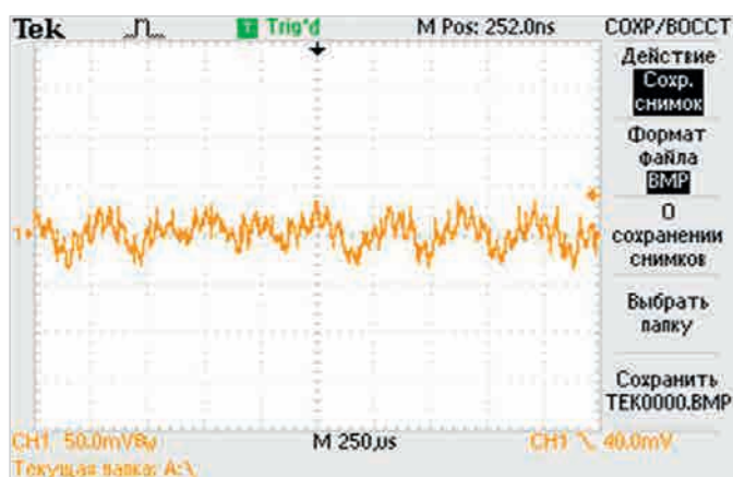
Рис. 7. Пульсации выходного напряжения двух параллельно включённых МП, работающих без синхронизации частоты преобразования
