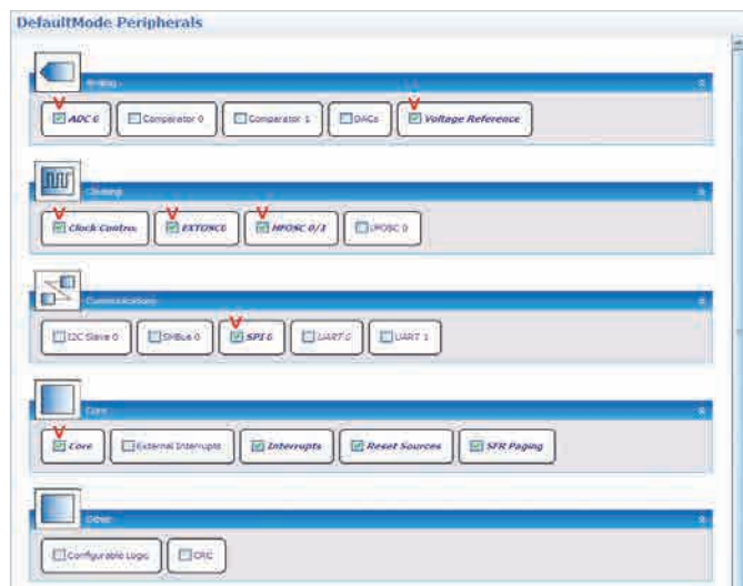
Рис. 6. Периферийные устройства LB12
