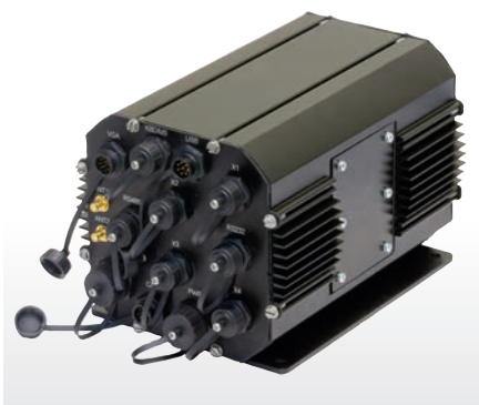
Рис. 3. МК307 – модульный компьютер для применения на транспорте
