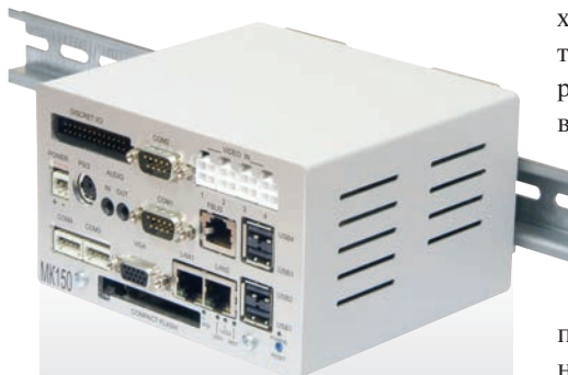
Рис. 5. МК150 – модульный компьютер с интерфейсом FBUS
