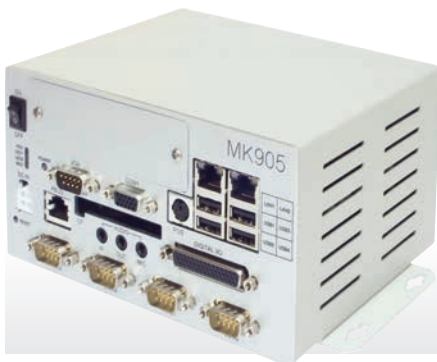
Рис. 6. МК905 – модульный компьютер с интерфейсом FBUS
