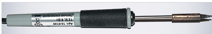
Рис. 38. Мини-паяльник 12 В, 8 Вт
