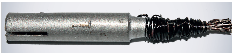
Рис. 60. Насадка-кисточка на паяльник 12 В (рис. 38)
