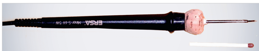
Рис. 36. Микропаяльник Ersa minor-S (6 В, 5 Вт)
