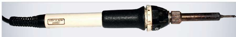
Рис. 40. Паяльник 220 В, 20 Вт
