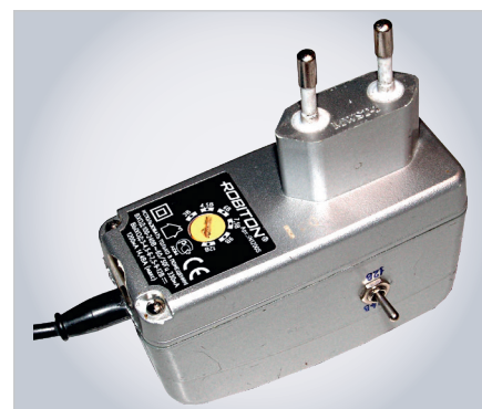
Рис. 39. Блок питания для микро- и мини-паяльников
