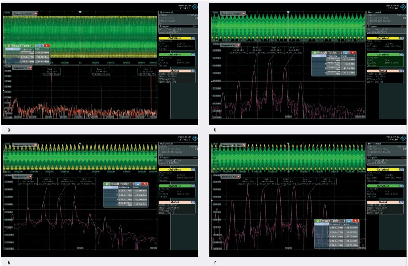
Рис. 9. Спектрограммы, полученные с использованием функции БПФ осциллографа R&S RTO2044: а) в режиме 1 для всех гармоник; б) в режиме 2 для первой гармоники; в) в режиме 2 для второй гармоники; г) в режиме 2 для третьей гармоники
