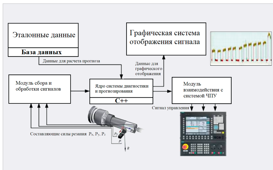
Рис. 2. Архитектурная модель системы диагностики и прогнозирования состояния режущего инструмента в реальном времени
