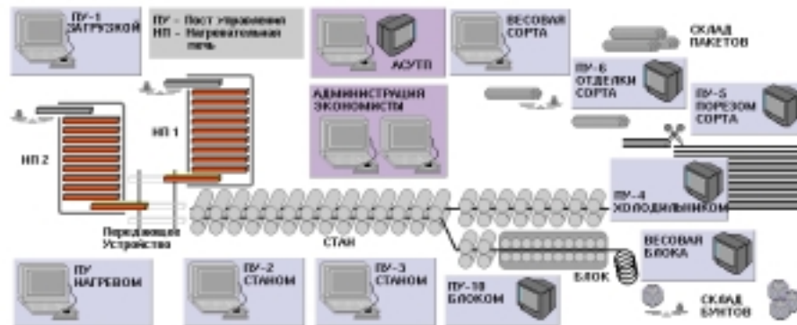
Рис. 1. Схема технологической линии сортопрокатного стана
