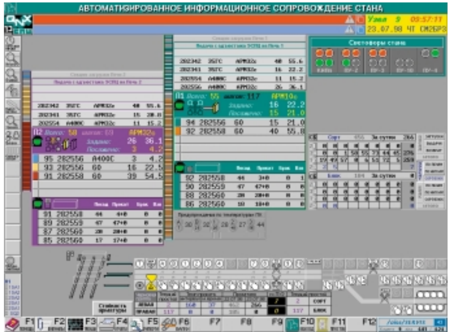
Рис. 6. Главная панель операторской станции поста стана, созданная в RTWin
