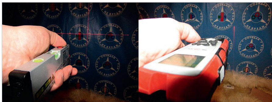
Рис. 21. Иллюстрация работы лазерного уровня и дальномера для строительных работ
