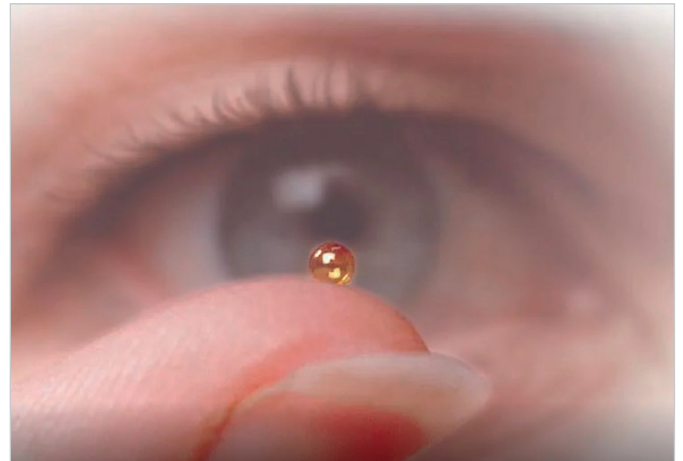
Рис. 10. Топливная мишень из дейтериево-тритиевой смеси в золотой оболочке (Lawrence Livermore National Laboratory)
