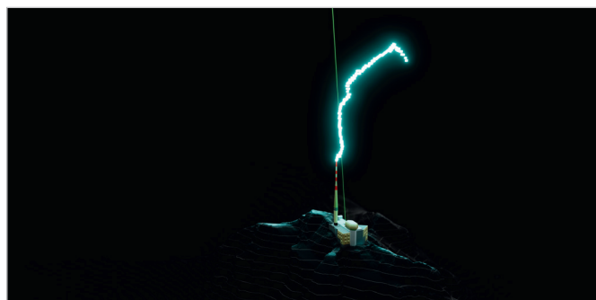
Рис. 2. Иллюстрация отклонения молниевых разрядов лучом мощного квантового генератора
