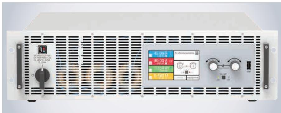
Рис. 1. Двунаправленный источник питания PSB 9000
